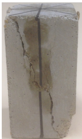
Figure IV.19 : L'état de rupture d'éprouvette à la fin d'essai.
