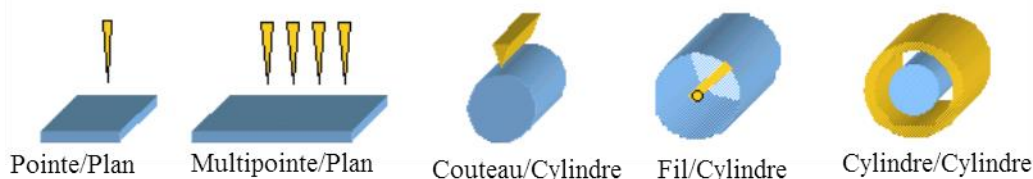
Figure I.12 - Systèmes d'électrodes couramment utilisés pour la production de décharges couronnes
