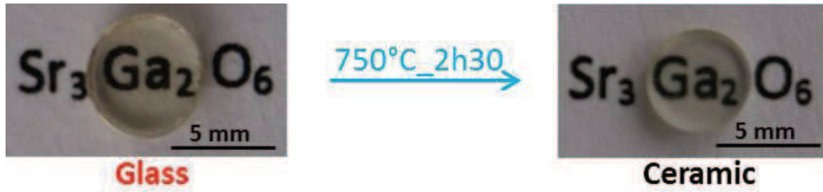
Figure 7 Verre de Sr_3Ga_2O_6 et sa céramique polycristalline transparente correspondante obtenue par un recuit du verre à 750 °C pendant 2 heures et 30 minutes
