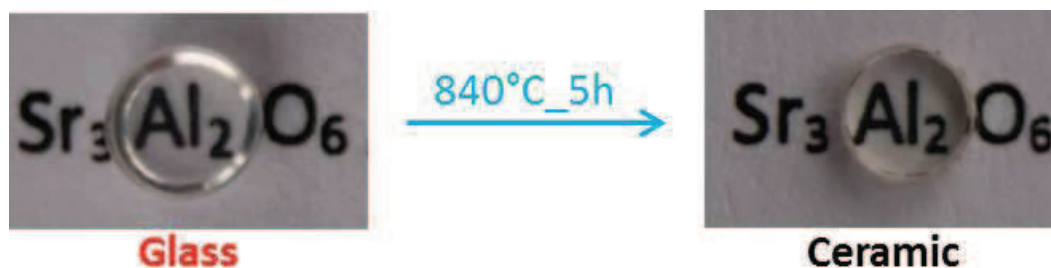
Figure 6 Verre de Sr_3Al_2O_6 et sa céramique polycristalline transparente correspondante obtenue par un recuit du verre à 840 °C pendant 5 heures
