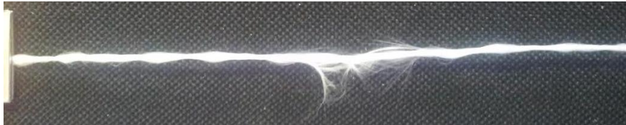
Figure 2.4. Mèche comélée après rupture.
