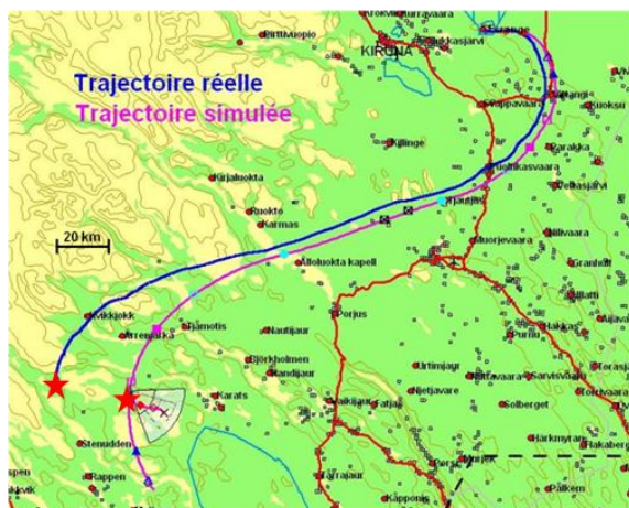
Figure 1.4. Prédiction de trajectoire (violet) et trajectoire réelle (bleu) d'un vol ballon à Kiruna. Les étoiles rouges représentent la séparation entre le ballon et la nacelle. Source : SSC Esrange, Suède.
