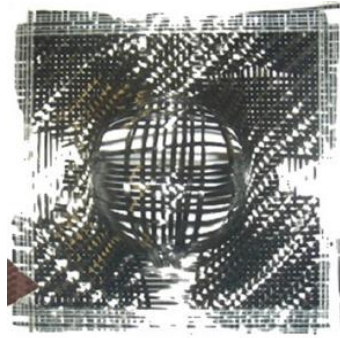
Figure 31 : Glissements du réseau de mèches observés par [GAT13]
