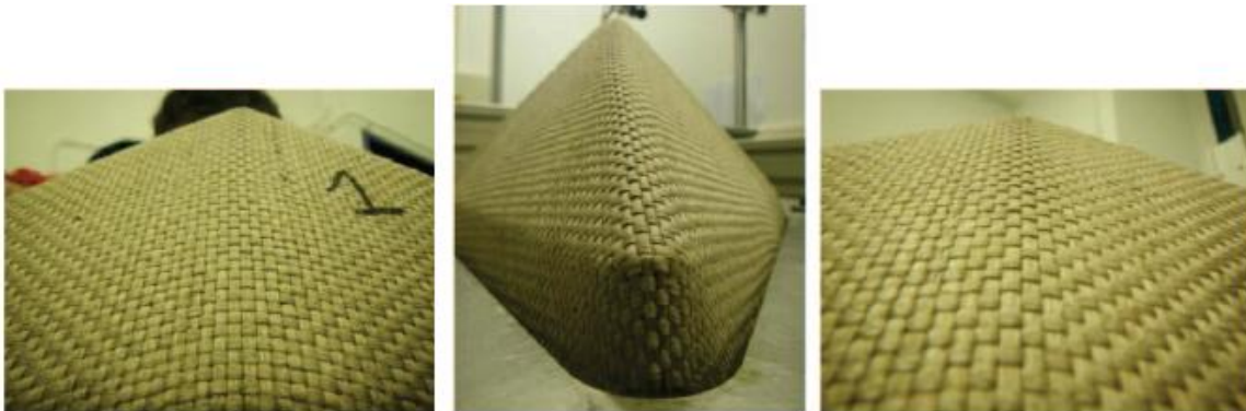
Figure 172 : Observations du défaut de boucles sur une mise en forme tétraédrique
