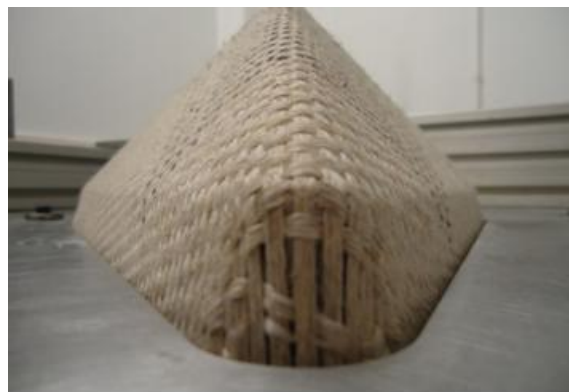
Figure 75 : Glissements renfort B, base BC à 5 bars et une orientation de 0°
