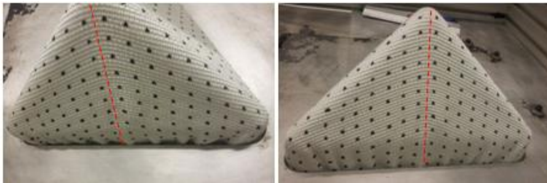
Figure 102 : Mise en forme tétraédrique 3D interlock de verre et ligne de bouclage théorique
