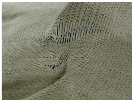
Figure 73 : Glissements observés sur la face B/base AB à 2,5 bars pour une orientation de 90^\circ
