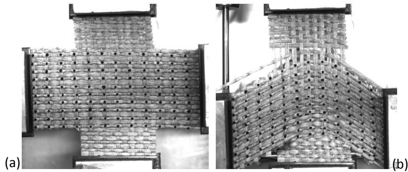
Figure 139 : Etat initial (a) et final (b) d'un essai avec géométrie croix
