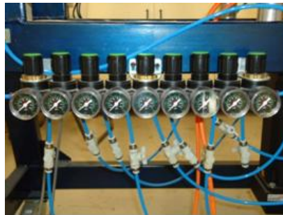
Figure 37 : Système de valves pour l'application des pressions serre-flan
