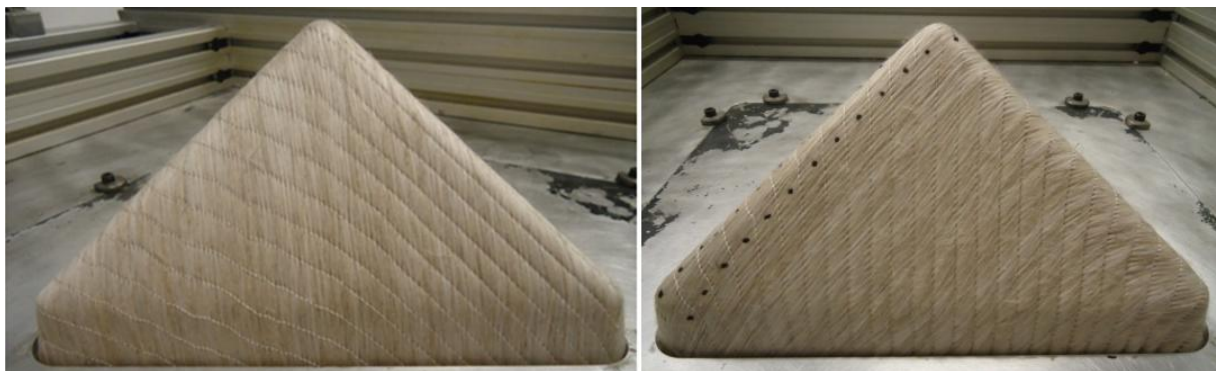
Figure 100 : Visualisation de la face A (a) et C (b) du tétraèdre sans boucles pour un renfort NCF
