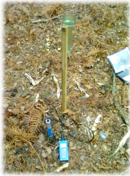
Photo 6 : Illustration d'un point de mesure et de la mesure de la teneur en eau volumique à l'aide d'une sonde TDR
