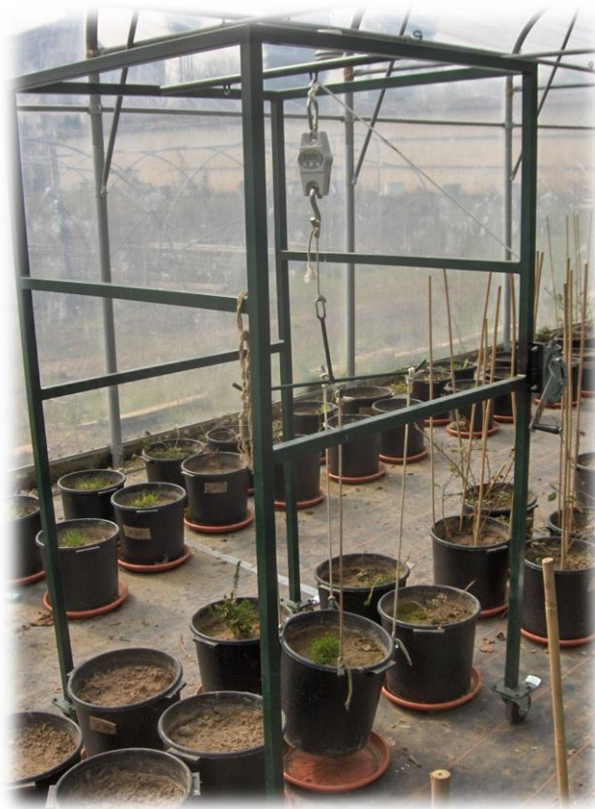
Photo 3 : Système de pesé des pots constitué d'un peson et d'un portique à roulettes réalisé en interne par Daniel Moreau et Franck Stocchero.
