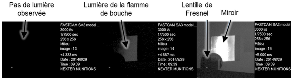
Figure V-9 : Images de la caméra rapide au moment de la sortie du projectile.
