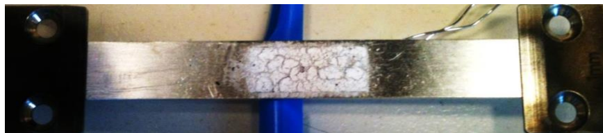
Figure 2-11. Échantillon corrodé à 1600 °C sur le ruban de platine
