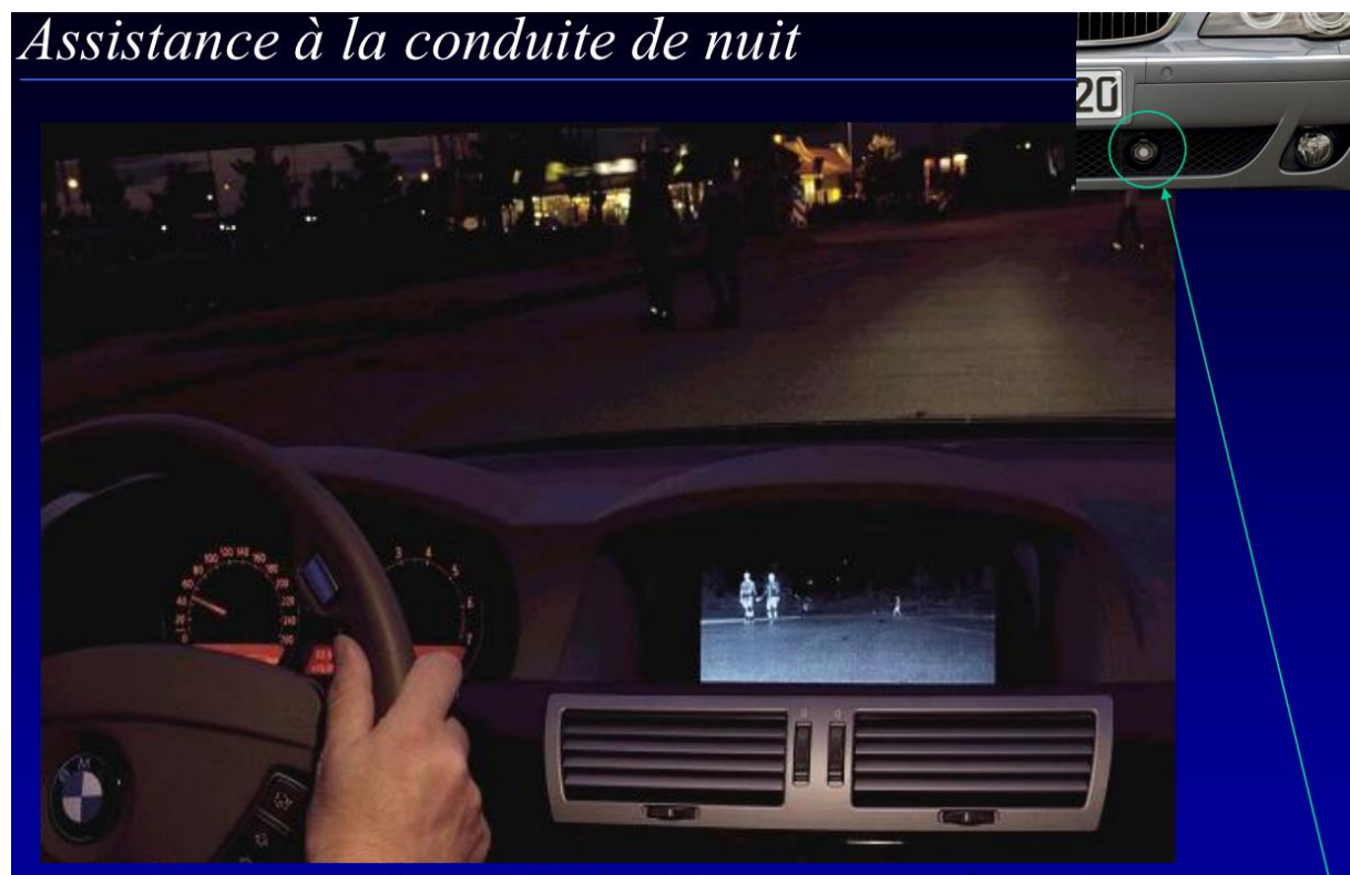
Figure 1-8 Photo de l'utilisation d'une caméra infrarouge d'aide à la conduite (8)
