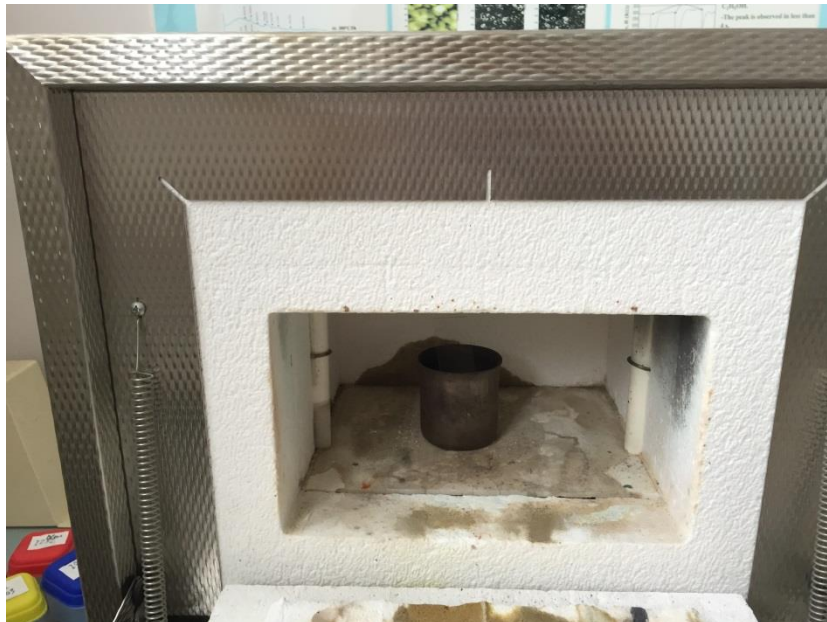
Figure 3-2 Montage expérimental utilisé du procédé dans le cas d'un échange ionique long
