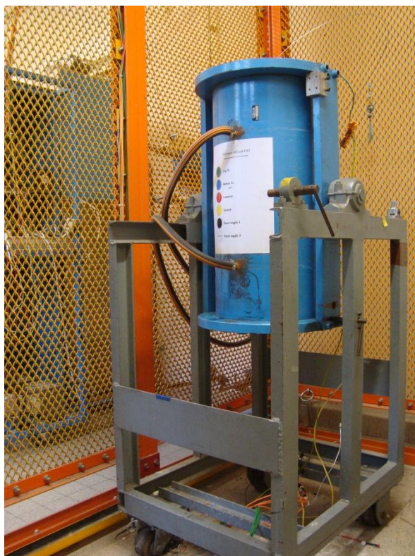
Fig. ii.4. Photo d'un des deux autoclaves à chauffage interne utilisés.
