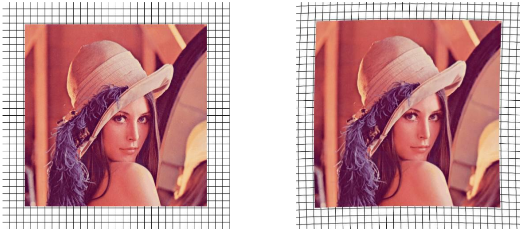
Figure 1-5- Illustration des déformations géométriques aléatoires engendrées par StirMark.
