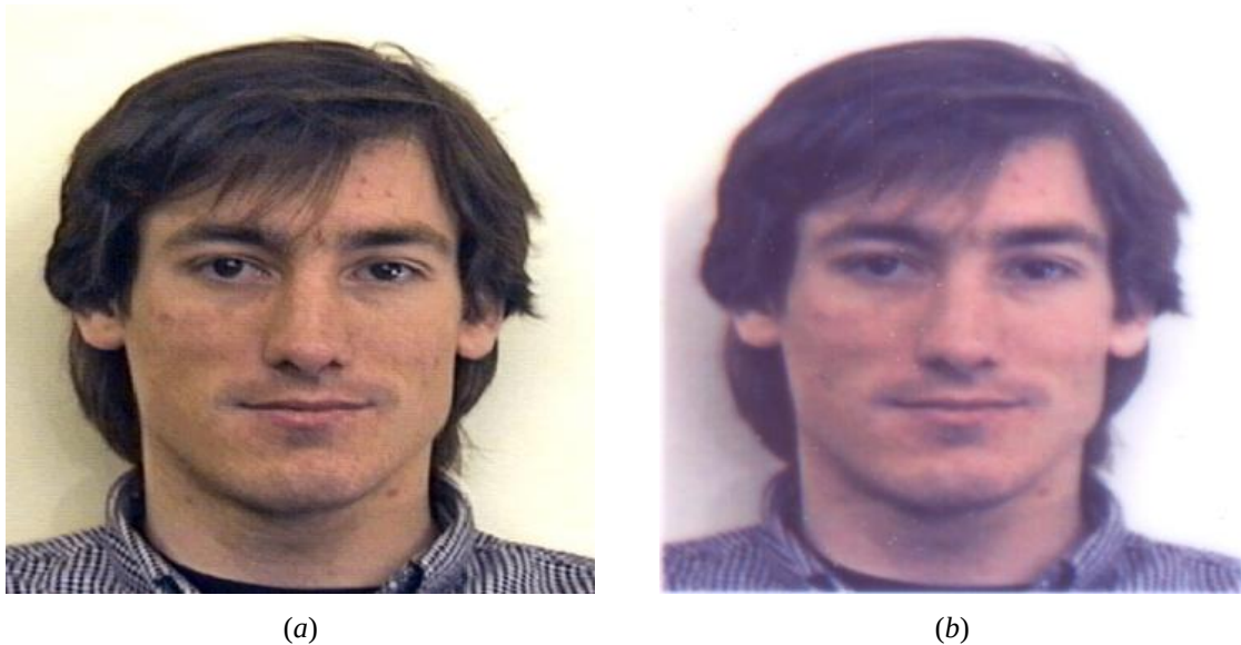
Figure 4-10- Exemple de distorsions résultantes d'une opération impression/numérisation. (a) Image numérique issue de la base d'image expérimentale, (b) la même image imprimée à 300 dpi et scannée à 300 dpi.
