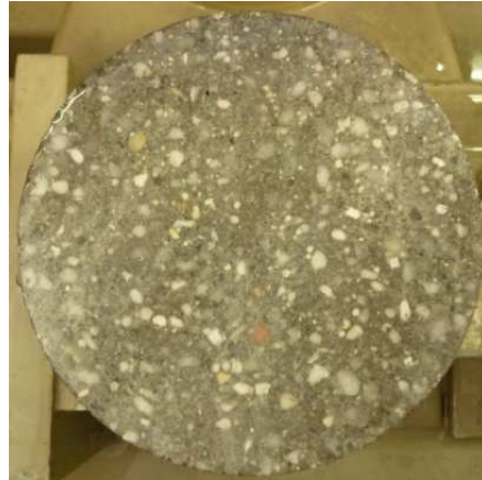
FIGURE 1.1 – Aspect de la surface d’une éprouvette de béton rectifiée
