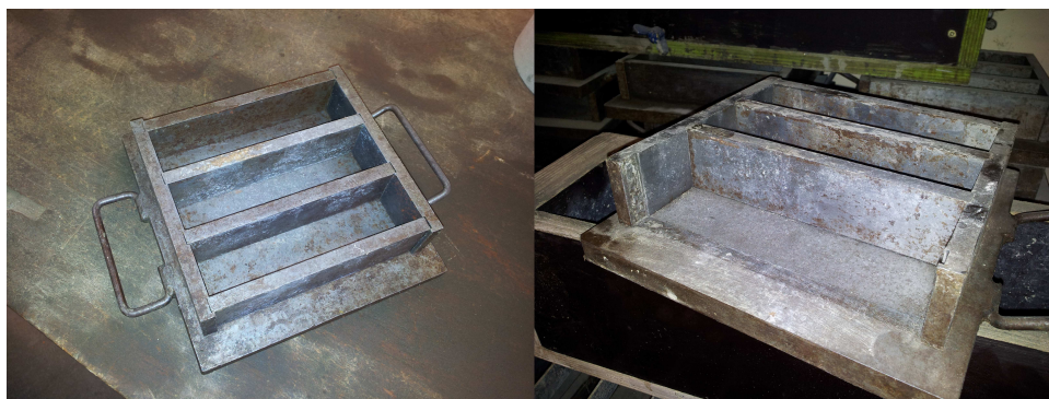
FIGURE 2.1 – Moules ayant servi à la fabrication des éprouvettes
