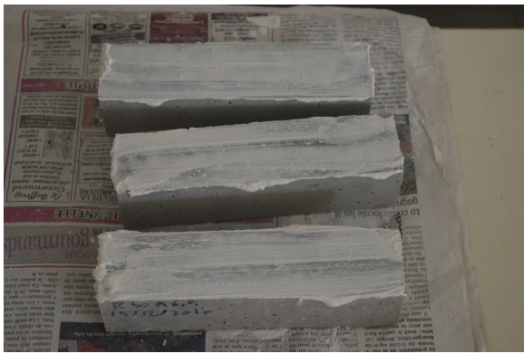
(a) Éprouvettes recouvertes de plâtre
