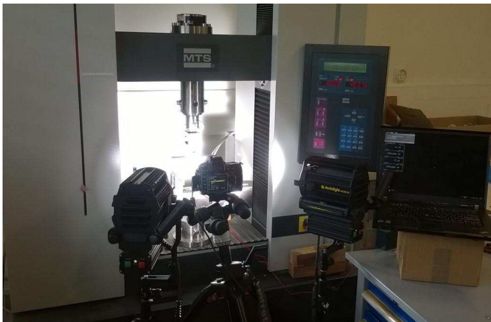
FIGURE 2.12 – Vue de l'essai statique : utilisation du Nikon D700
