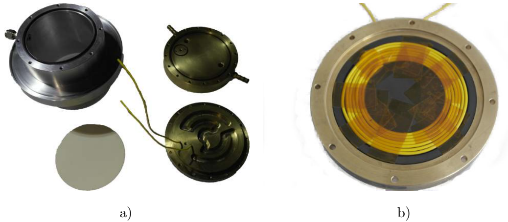
FIGURE 5.3 – a) Corps du propulseur avec le circuit de refroidissement. b) Antenne d'induction emprisonnée dans une ferrite.
