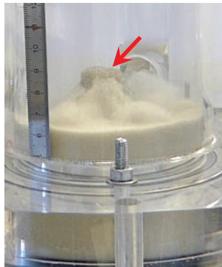
Figure 48. Photographie du lit à H/D=0,5 : amas de particules immobiles
