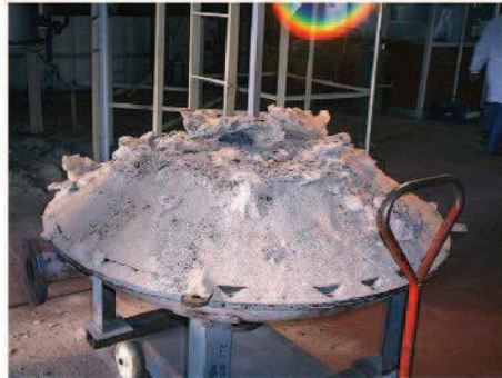
Figure 15. Photographie d'un lit aggloméré après refroidissement et extraction du réacteur (Llorente, 2006)
