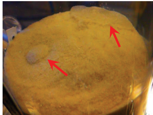
Figure 56. Photographie de la surface du lit après disparition du bullage
