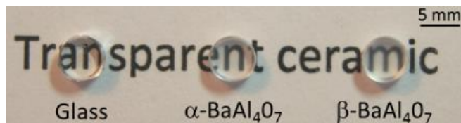
Figure III.1 : Photographie des billes de verre et céramiques de \text{BaAl}_4\text{O}_7 (formes \alpha et \beta ), après polissage pour obtenir un disque de 1 mm d'épaisseur et 5 mm de diamètre.
