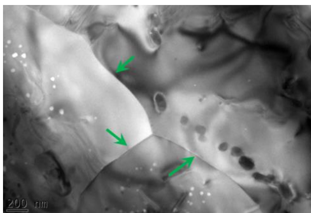
Figure IV.41 : Micrographie MET de joints de grains fins (pointés par des flèches vertes) dans la céramique de \text{Sr}_{0,6}\text{Tb}_{1,4}\text{Ga}_3\text{O}_{7,2} après mesure de conductivité.
