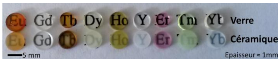
Figure IV.3 : Photographie des verres et céramiques polycristallines de \text{SrREGa}_3\text{O}_7 obtenues par cristallisation complète du verre grâce à un simple traitement thermique. Les échantillons sont polis sur deux faces parallèles.
