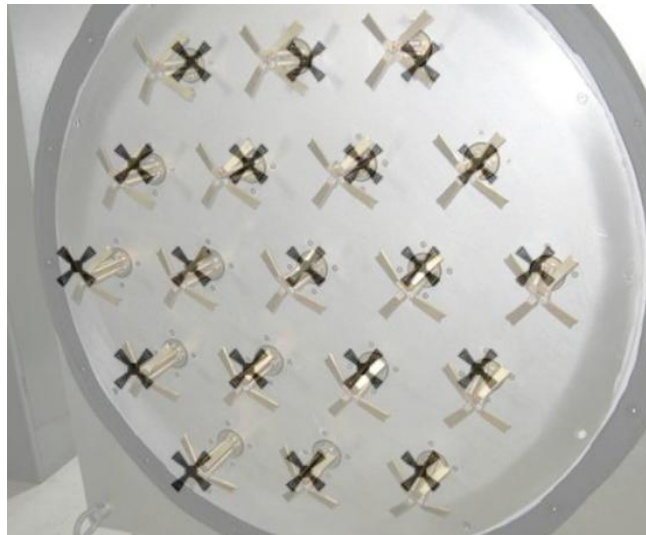
Figure 3.131 : Configuration d'un mini-réseau de 19 antennes NenuFAR
