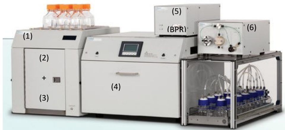
Figure 4-13 : Extracteur supercritique (MV10-ASFE) de la société Waters [230].
