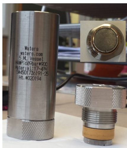
Figure 5-2 : Représentation de la cellule d'extraction / d'imprégnation de 5 mL (Waters).
