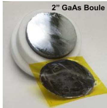
Figure 23 : photographie d'une couche d'Arséniure de Gallium détachée depuis le lingot par Controlled Spalling
