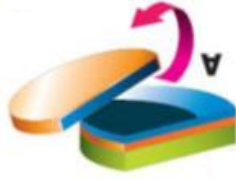
Figure 28 : Schéma du clivage du wafer A dans la zone implantée d'hydrogène
