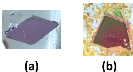
Figure 36 : Photographie d'un germe de silicium détachée (a) avant dépôt et (b) après dépôt d'une couche de silicium amorphe nanocristalline d'une épaisseur de 1 \mu\text{m} .
