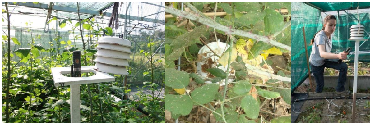
Photo 2. Mesure du microclimat. Photographie a) d'un capteur thermo-hygromètre et de son abri au-dessus du roncier pour la caractérisation de l'environnement, b) d'un capteur thermo-hygromètre et de son abri sous roncier 15 cm au-dessus du sol pour la caractérisation des conditions microclimatiques sous roncier, c) du relevé d'un des thermohygromètres du dispositif. Dispositif en conditions semi-contrôlées PépiRoCh.
