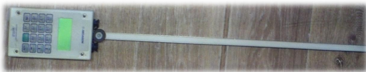
Photo 4. Ceptomètre modèle PAR-80 utilisé pour la caractérisation de l'environnement lumineux dans le dispositif en conditions semi-contrôlées PépiRoCh.
