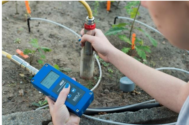
Photo 3. Mesures d'humidité relative du sol grâce à une sonde TDR de type TRIME-pico IPH.
