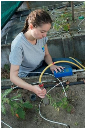
Photo 3. Mesures d'humidité relative du sol grâce à une sonde TDR de type TRIME-pico IPH.
