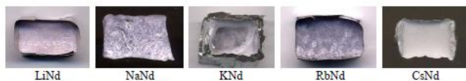
Figure 6 : Observations macroscopiques des verres \text{SiO}_2 - \text{B}_2\text{O}_3 - \text{Al}_2\text{O}_3 - \text{M}_2\text{O} - \text{CaO} - \text{ZrO}_2 - \text{TR}_2\text{O}_3 après un refroidissement de 1°C/min dont la nature de l'alcalin est variable ( M : \text{Li}^+, \text{Na}^+, \text{K}^+, \text{Rb}^+ et \text{Cs}^+ ) 1 .
