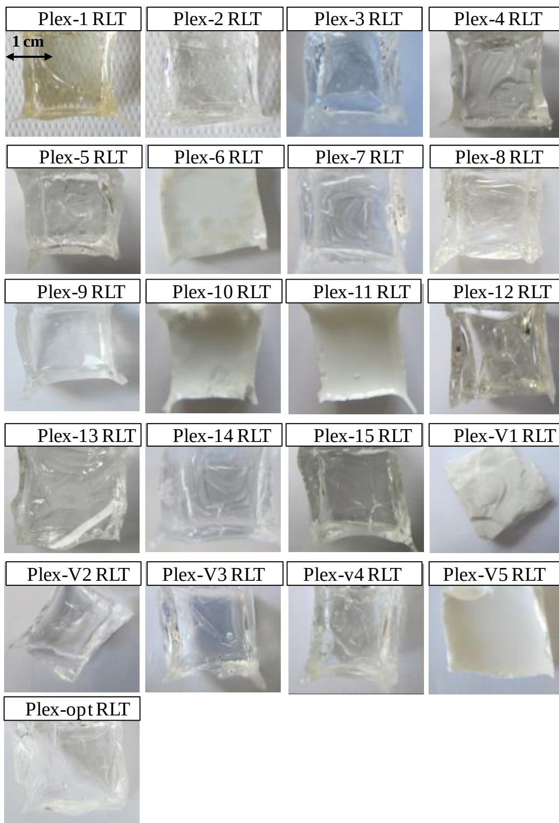
Figure 5 : Observations macroscopiques des quinze verres du plan d'expériences et des six verres de validation refroidis à 1°C/min.
