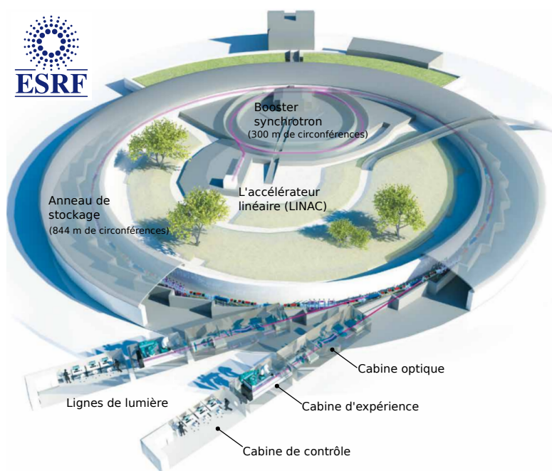
Figure I.12 – Schématisation du synchrotron de l'ESRF de Grenoble (d'après [100])
