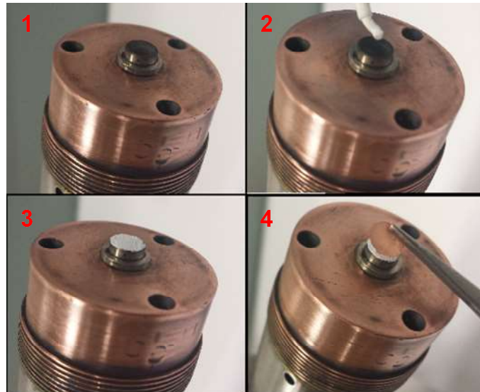
Figure II. 7. Procédure de positionnement de la pastille de cuivre avec la patte thermique sur le capteur
