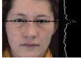
FIGURE 3.8 – Projection horizontale des gradients pour la détection de l'axe des yeux
