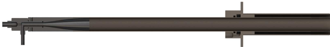
FIGURE 4.18 – Schéma du premier prototype de brûleur (prototype 1).
