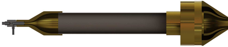
FIGURE 4.21 – Schéma du deuxième prototype de brûleur (prototype 2).
