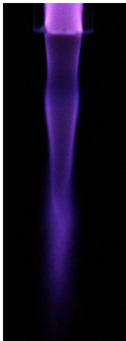
Figure A-12 : plume plasma en sortie d'un capillaire de 4 mm de diamètre interne pour un débit proche de 10 l/min et une fréquence de répétition de 1 KHz.
