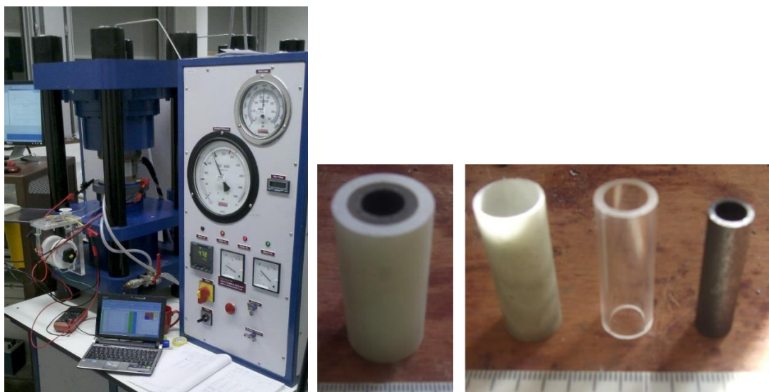
Fig. 5 (photo piston cylindre) et assemblage piston cylindre.
