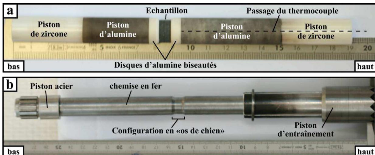
**Figure V-4:** (a) photo de la colonne-échantillon sans chemise, constitué d'un assemblage de pistons (alumine, zircone) et de disques d'alumine répartis de part et d'autre de l'échantillon. Les cylindres de la demi-colonne supérieure sont forés en leur centre, laissant un passage pour le thermocouple. (b) Photo de l'assemblage moulé par sa chemise en fer (colonne-échantillon de type « os de chien »).
