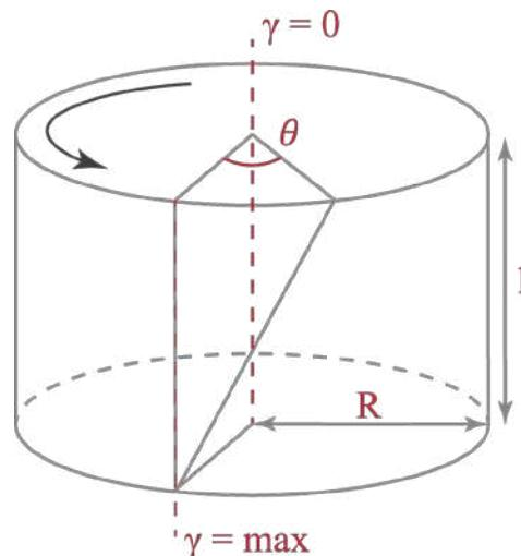
**Figure V-5:** schéma d'un échantillon de forme cylindrique ( $R$  : rayon ;  $l$  : longueur) soumis à une déformation en torsion sous presse Paterson. L'angle  $\theta\theta$  représente le déplacement angulaire.
