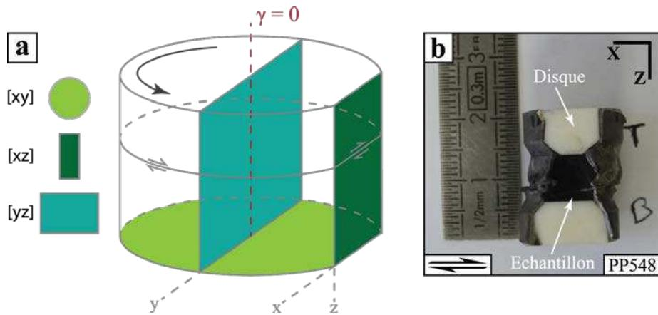
**Figure V-7:** sections d'étude pour analyse chimique ou observation texturale/structurale. (a) Schéma représentant les trois sections le plus souvent réalisées au travers des échantillons cylindriques. (b) photo d'un échantillon déformé en torsion et scié avec ses disques et sa chemise selon une section [xz] ; expérience PP548.
