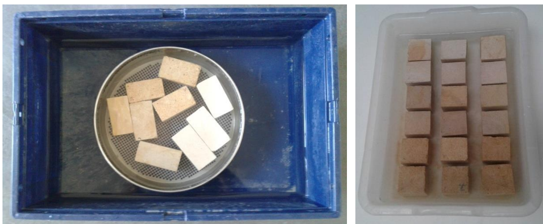
Figure II-18 Essais de vieillissement artificiel: a) Choc thermique (b) Cristallisation de \text{Na}_2\text{SO}_4
