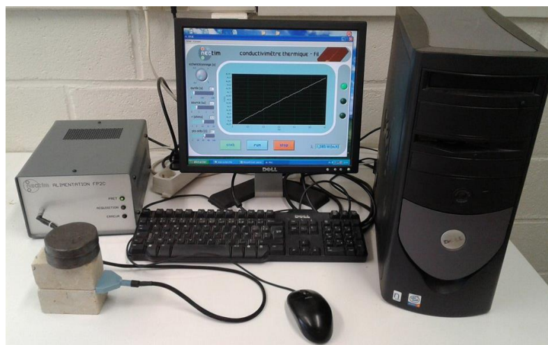
Figure II-13 Conductimètre du fil à chaud
