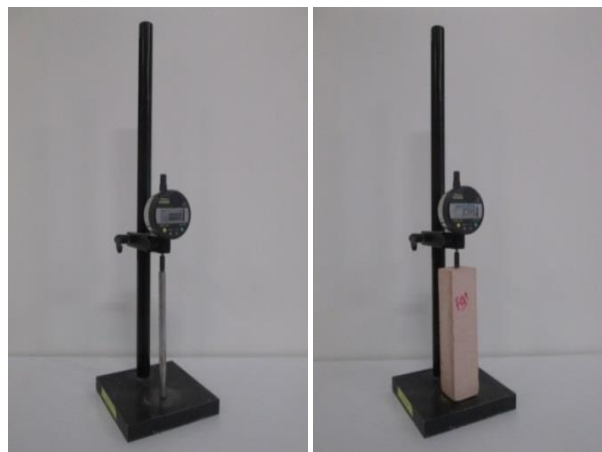
Figure IV-14 Dispositif de mesure de retrait : a) Etalonnage b) Mesure de retrait
