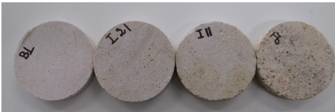
Figure II-2 Aspect visuel des trois sous faciès de calcarénite sur 4 échantillons (disques de diamètre 5cm, blanchâtre (à gauche), jaunâtre (à droite) et intermédiaires (au milieu))
