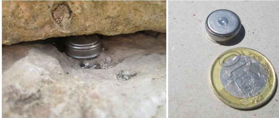
Figure III-2 Boutons enregistreurs de température et d'humidité
