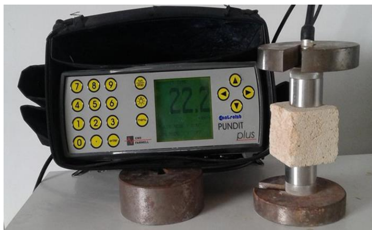
Figure II-19 Appareil à ultrasons Pundit
