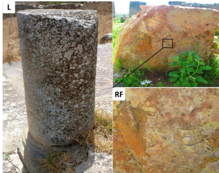
Figure III-17 Lichen et rubéfaction avec desquamations en feuillets (L, RF)
