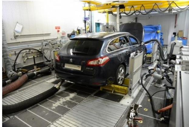
Figure 5 : Banc à rouleaux utilisés pour mesurer les émissions (Source : Groupe PSA)
