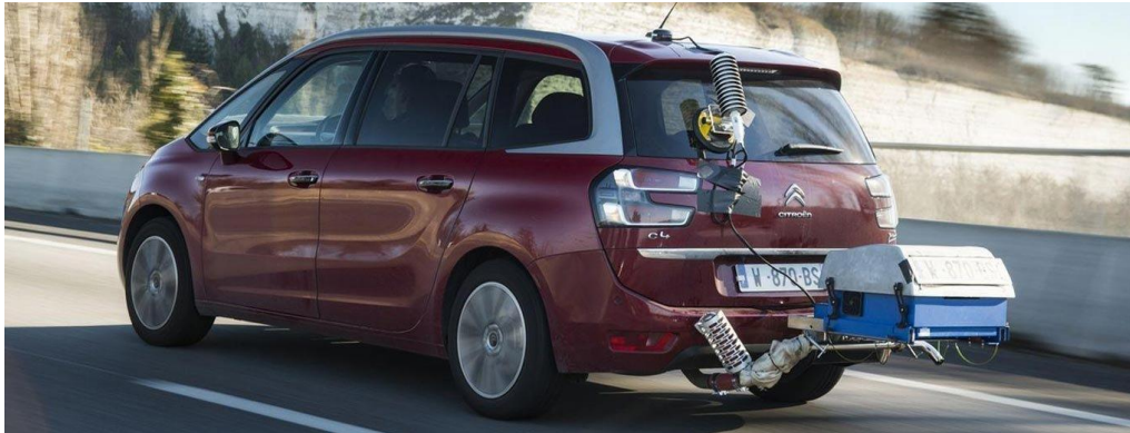
Figure 8 : Véhicule équipé d'un système portable de mesure d'émissions (PEMS) (Source : Transport & Environment)
