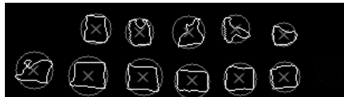
FIGURE 4.12 – Détection des centres et des cercles englobants de chaque motif formant le décor.
