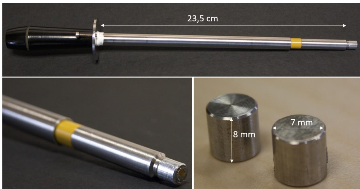
Figure 2-10 : Photos de la canne de transfert permettant l'insertion du porte-échantillon (photo de droite, en bas) dans la première chambre à vide.
