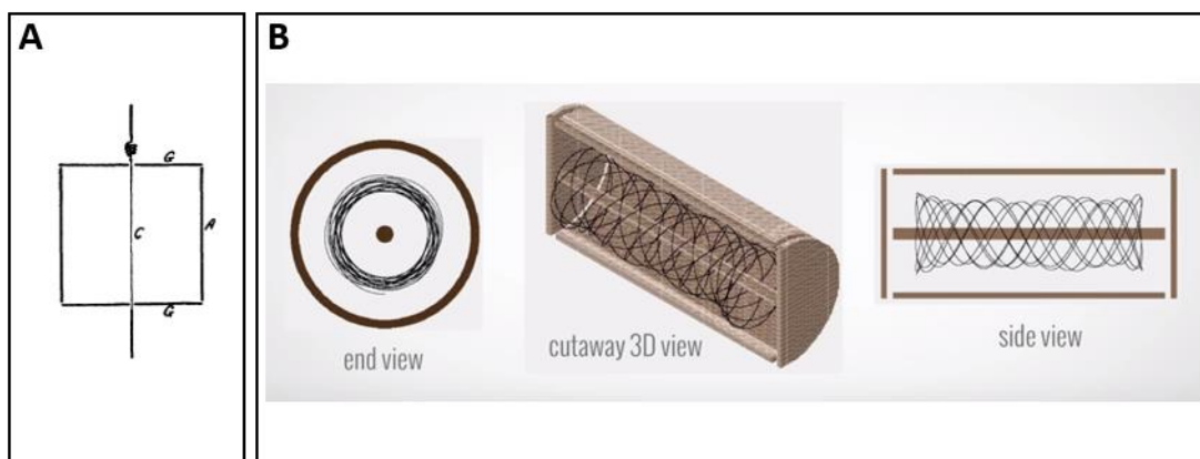
Figure 2-1 : Illustration du piège de Kingdon (A) tirée de Kingdon, 1923 représentant le fil central et la cavité cylindrique dans laquelle il est inclus; (B) selon trois vues (depuis l'extrémité, en coupe 3D et de côté) du piège ainsi que le mouvement des ions à l'intérieur (crédit : MASS SPEC PRO).
