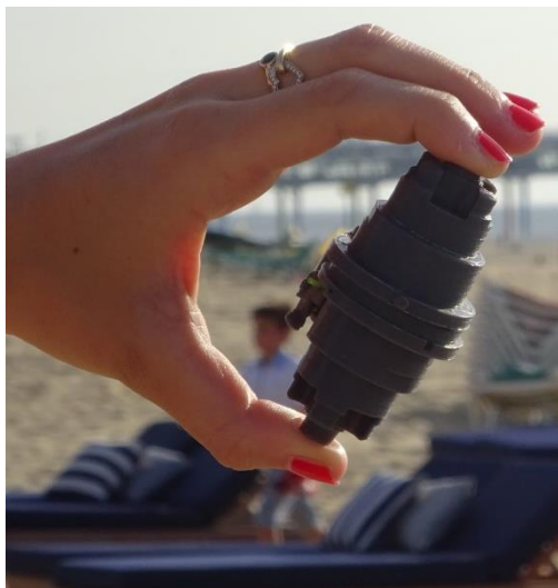
Figure 2-6 : Reproduction d'une cellule Orbitrap à l'imprimante 3D à l'échelle 1. S'agissant d'un modèle D30, la cellule fait 30 mm de diamètre pour 40 mm de longueur.
