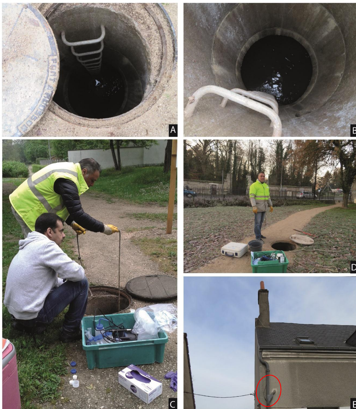
Figure 2-5: A : Photo du regard du réseau EP en aval du bassin versant de l'Egouttier par temps sec (12/12/2016). B : par temps de pluie (01/03/2017). C et D : Photos du regard du réseau EP en aval du bassin versant de l'Egouttier où les prélèvements ont été effectués. E : Raccordement d'une évacuation d'EU au réseau d'EP.
