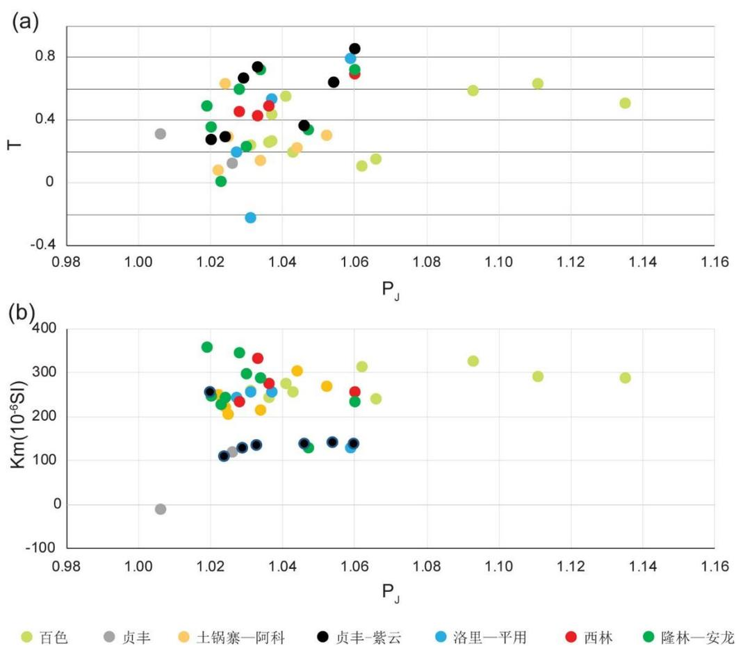
图 7.2 南盘江盆地中三叠统砂岩 AMS 椭球体性状参数图 (a)  $P_j$ - $T$  双变量图解; (b)  $K_m$ - $P_j$  双变量图解
