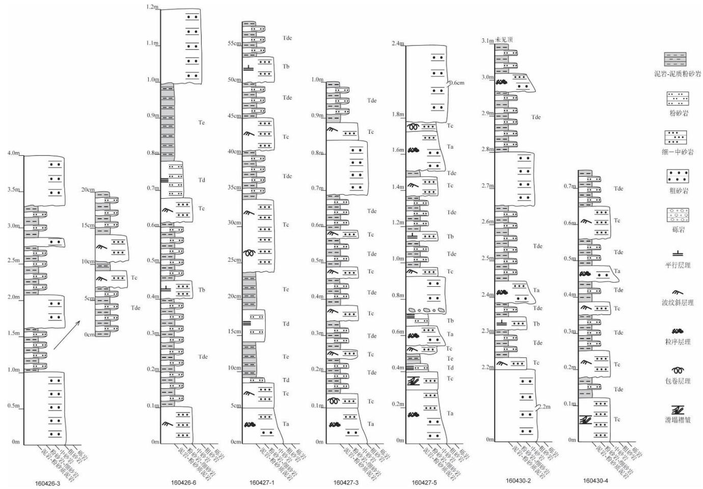
图 3.31 定安—潞城—龙车三叠系沉积柱状图 (续)
