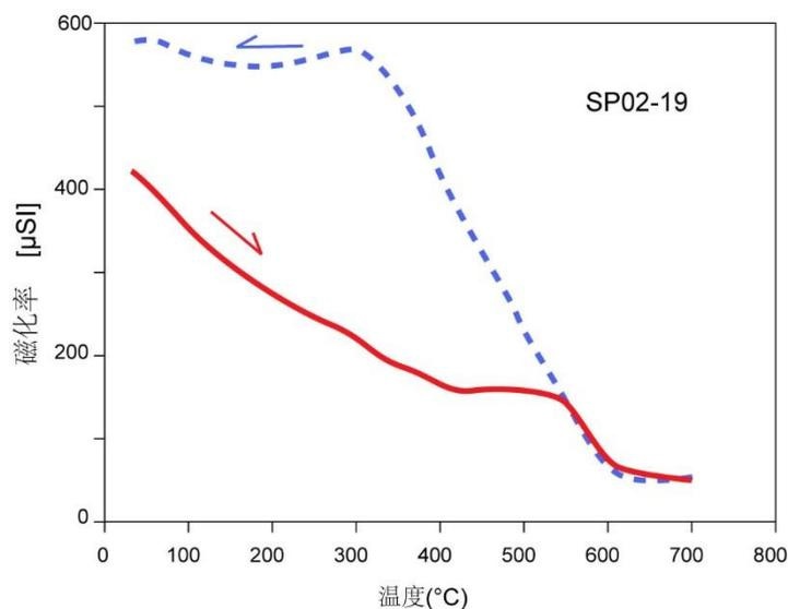
图 7.1 南盘江盆地中三叠统砂岩热磁曲线
