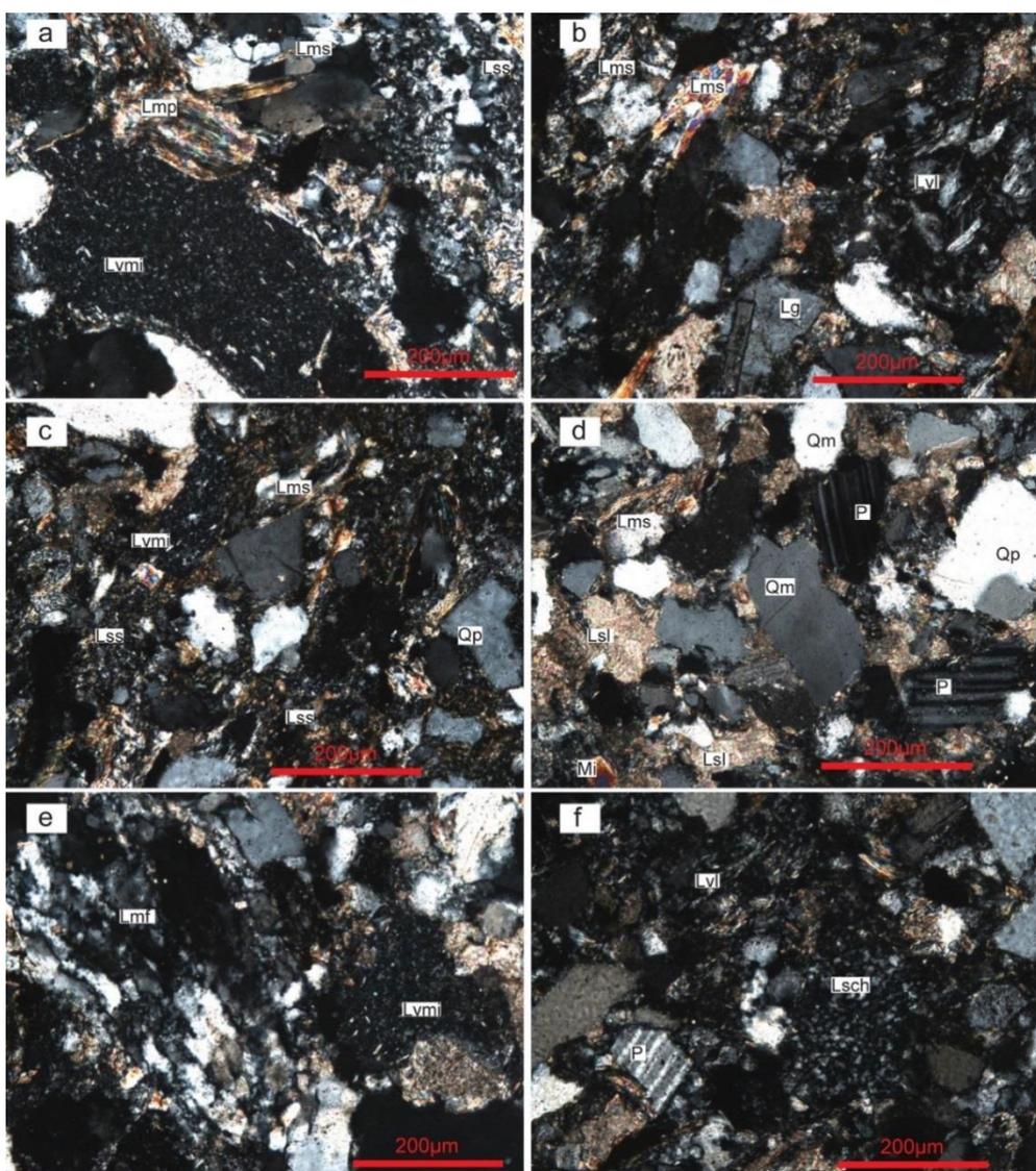
图 5.3 南盘江盆地中三叠统砂岩显微镜下照片（正交光）
