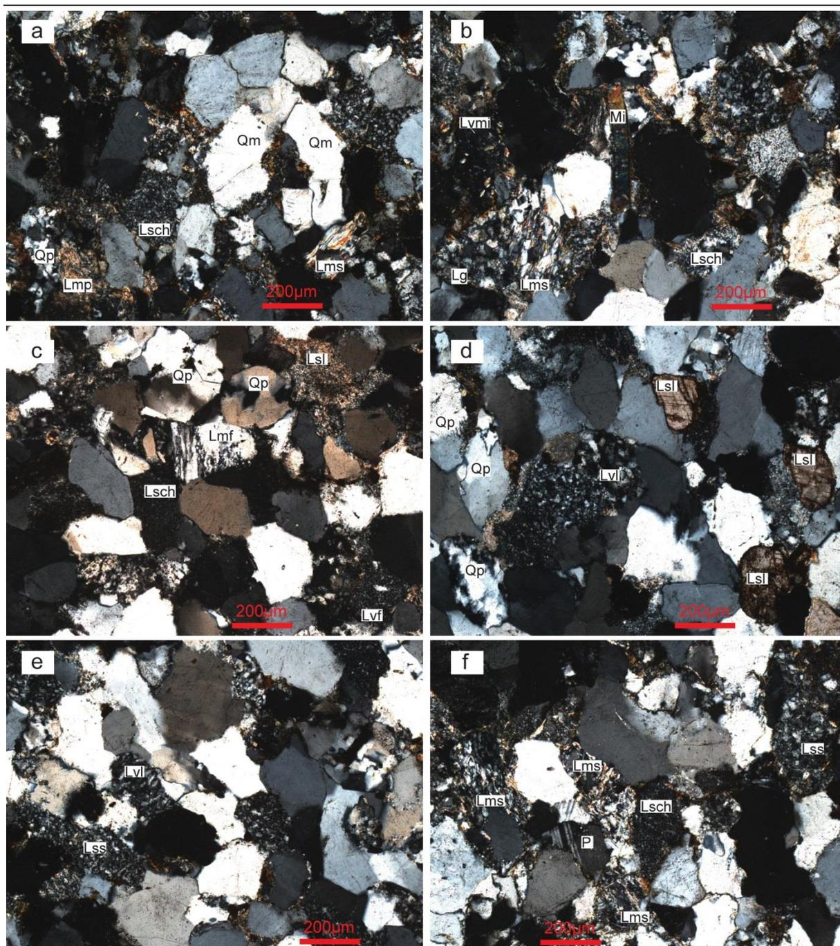
图 5.5 南盘江盆地上三叠统砂岩显微镜下照片（正交光）
