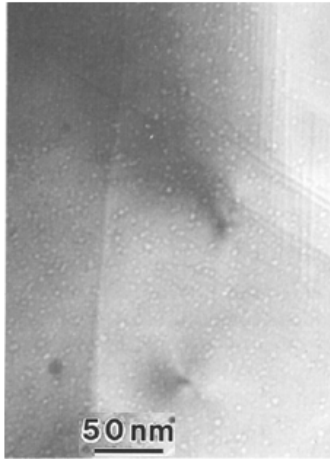
Figure 6 – Image MET d'une lame mince d' \text{UO}_2 irradié à 23 \text{GWj/t}_U [37]
