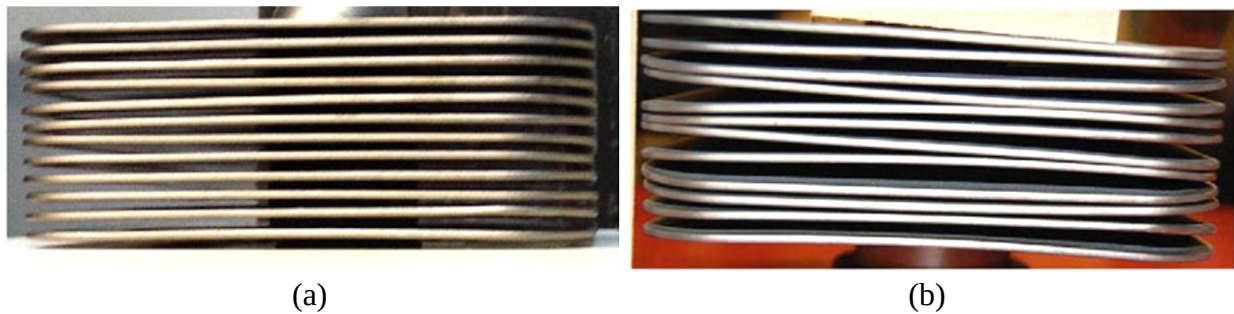
Figure I.12 : Membranes de forme de plaque (a) à l'état initial ; (b) après 625 jours de fonctionnement montrant des signes de fluage des membranes [Anderson 2016]
