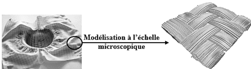
Figure 1.9 : Modélisation du renfort à l'échelle microscopique : les fibres sont considérées comme un matériau homogène. [D. Durville, 2012]
