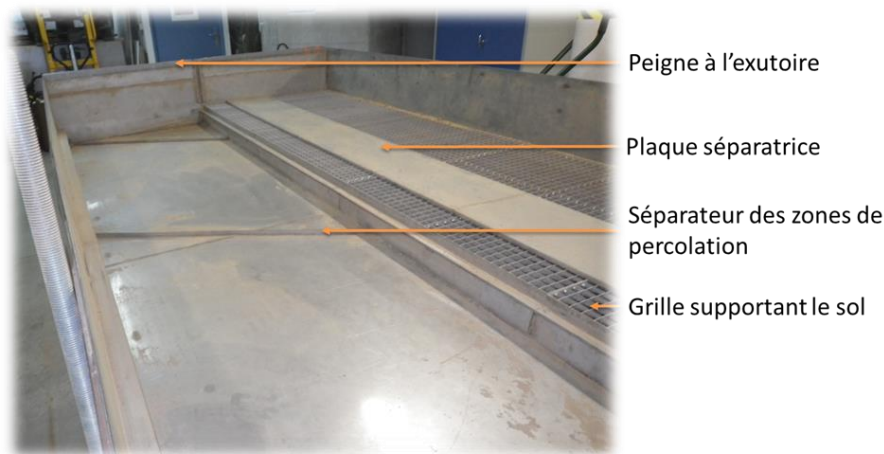
Figure 3-1 : Infrastructure du dispositif expérimental à vide
