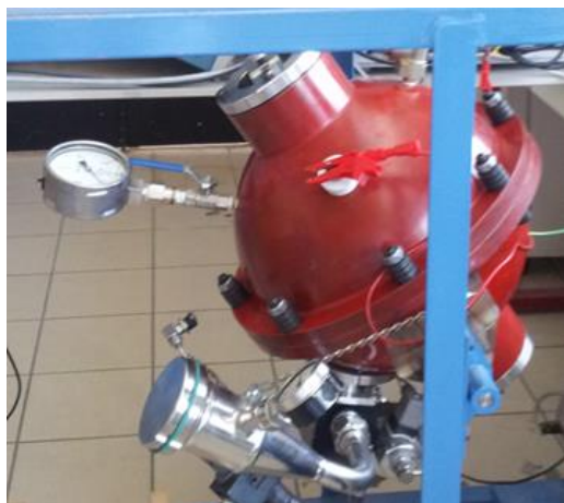
Figure III.43 - Sphère de 20 L utilisée et allumage électrique
