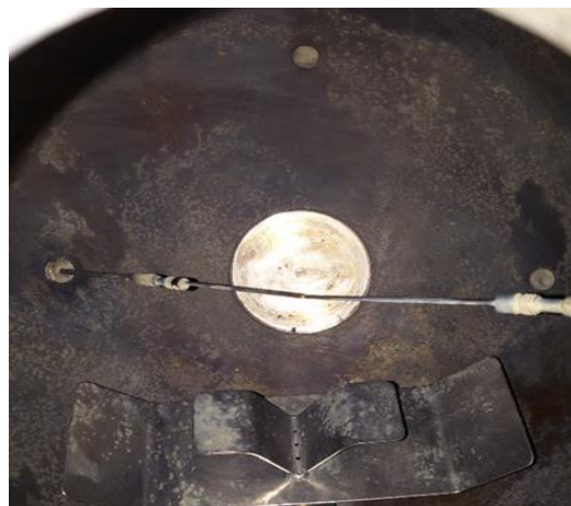
Figure III.43 - Sphère de 20 L utilisée et allumage électrique
