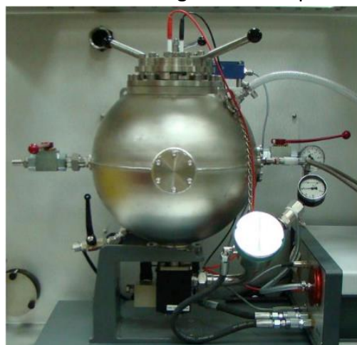
Figure III.44 - Sphère de 20 L Kühner du standard et allumage pyrotechnique
