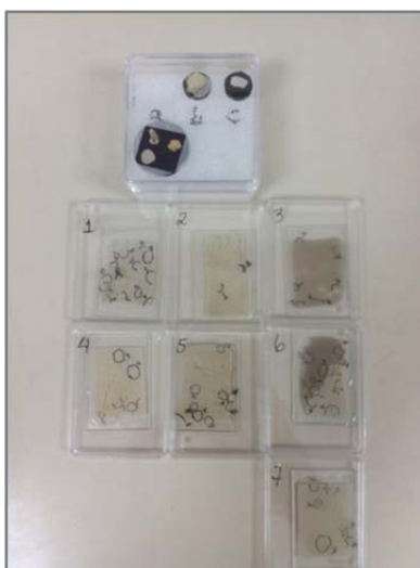
Figure 9- 10 Echantillons observés au MEB. Lames minces après repérage sous microscope optique et métallisation. Echantillons intacts en haut de la figure.
