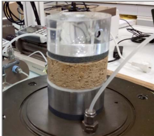
Figure 7- 12 Préparation de l'échantillon pour la mesure de propriétés hydriques. Du bas vers le haut : piédestal avec céramique poreuse, papier filtre, pâte de silice, échantillon, papier filtre, pierre poreuse et chapeau drainant.
