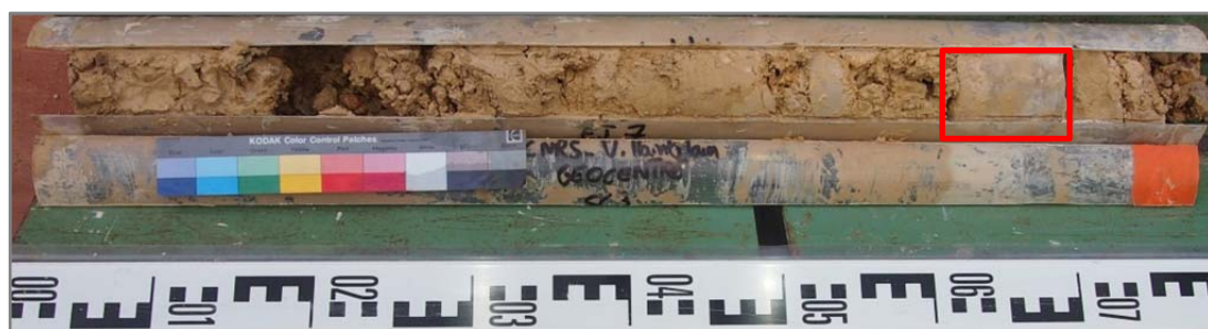
Figure 11- 26 EI-7 du SC3 (6 à 6,8 m). Roche dure (rectangle rouge)
