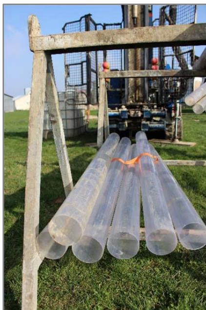
Figure 10- 5 Gaines transparentes pour le carottage à l'eau avec le carottier triple.
