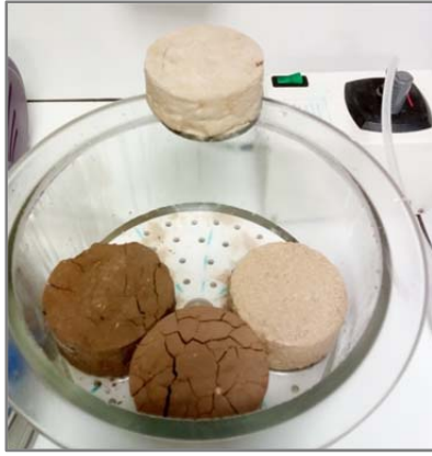
Figure 9- 12 a) Saturation des échantillons cylindriques sous vide dans un cristallisateur, b) saturation des mottes avec un bac à sable.
