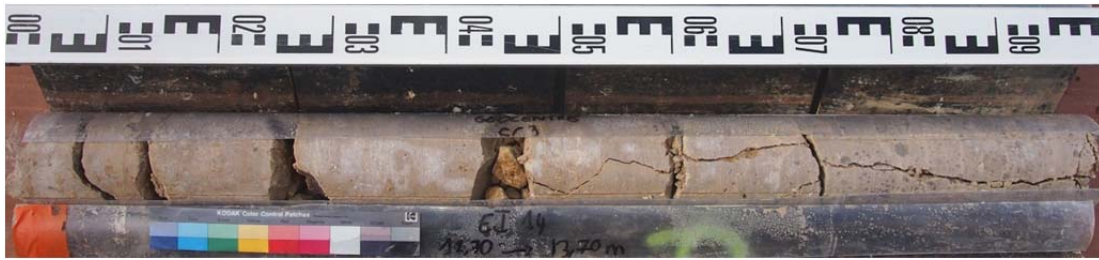
Figure 11- 14 Roche calcaire saine avec des fractures (12,7-13, 7 m-SC3).
