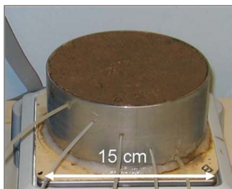
Figure 4- 3 Schéma du montage utilisé pour la méthode de Wind (Frison, 2008).
