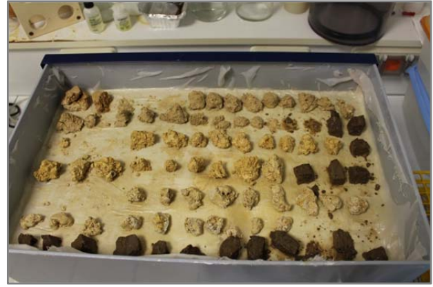
Figure 9- 12 a) Saturation des échantillons cylindriques sous vide dans un cristallisateur, b) saturation des mottes avec un bac à sable.
