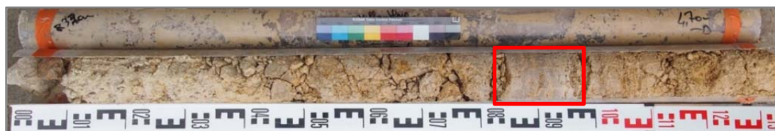
Figure 11- 24 Différents états d'altération dans la roche calcaire micritique. EI-4 du SC1 (3,2 à 4,6 m). Roche dure (rectangle rouge)
