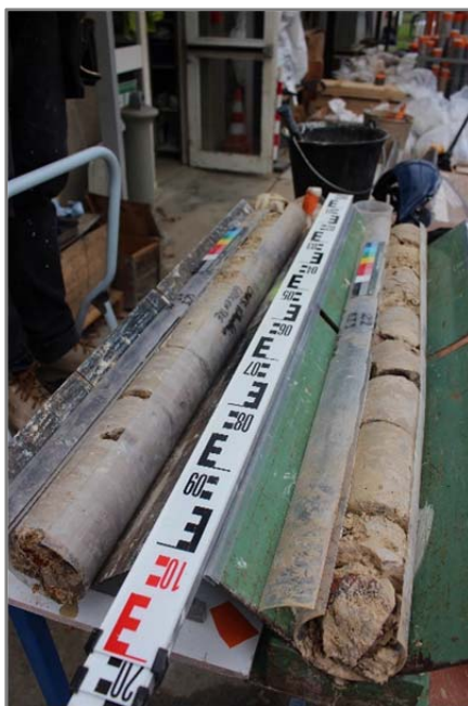
Figure 10- 6 Ouverture de carottes pour la description lithologique.
