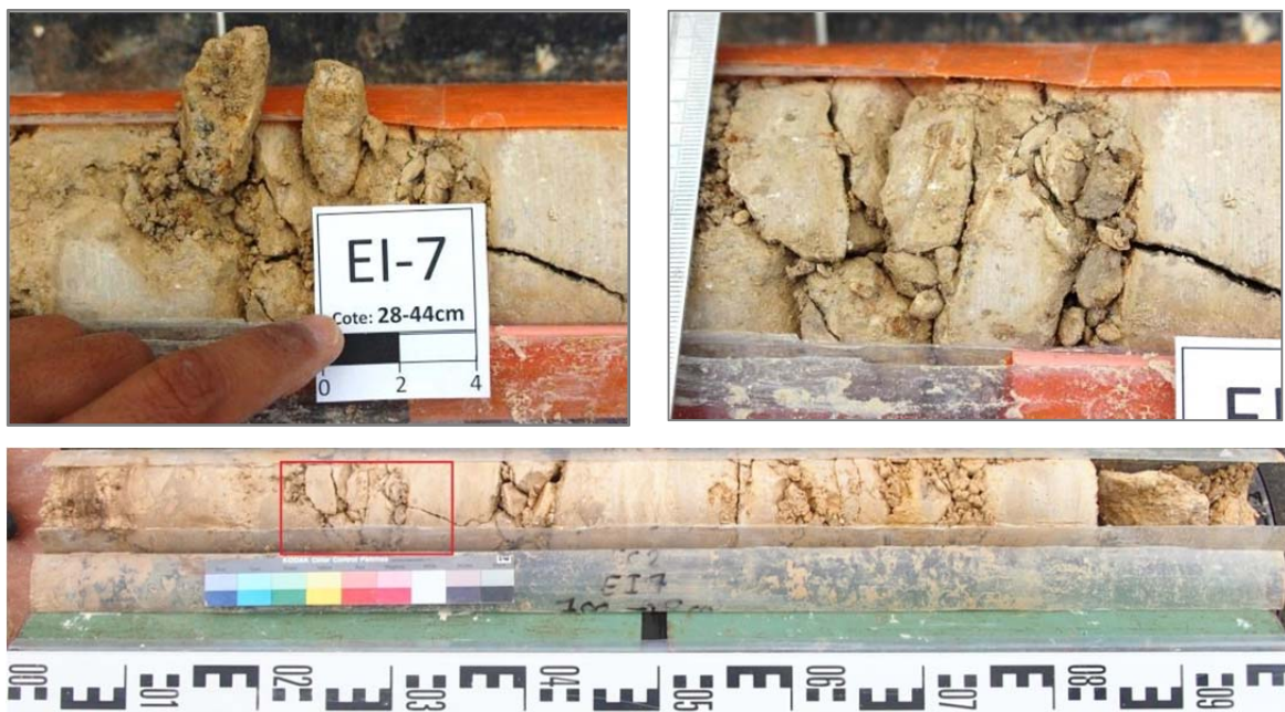
Figure 13- 7 Échantillonnage pour la diffractométrie X sur lame orientée (7,28-7,44 m-SC2).
