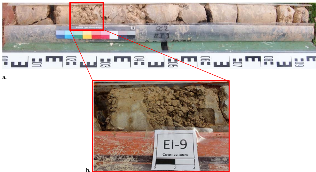
Figure 11- 19 a) Calcaire micritique grisâtre très fracturé, EI9-SC2 (9 à 10 m), b) zone d'accumulation et d'altération.
