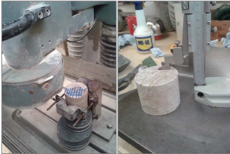
Figure 10- 12 Rectification d'un échantillon de roche à l'aide d'un lapidaire et d'un pied à coulisse.
