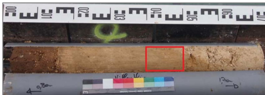
Figure 12- 4 Echantillon de marne calcaire prélevé (rectangle rouge) pour l'analyse granulométrique (1,2 à 1,3 m de profondeur-SC1).
