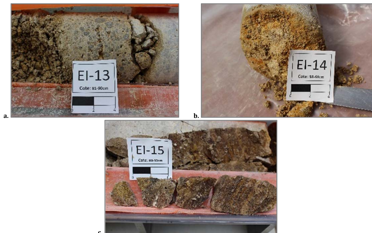
Figure 10- 8 Sous-échantillonnage : a) d'un faciès de calcaire gravier, b) d'un faciès de roche calcaire altérée, c) d'un profil de fracture d'une roche saine.
