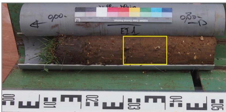
Figure 12- 1 Prélèvement d'un échantillon de sol (rectangle jaune) pour analyse granulométrique (30 à 40 cm, SC1).
