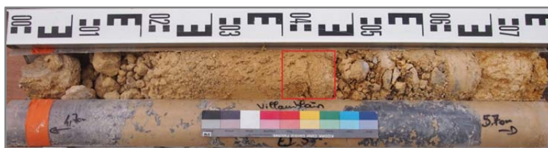
Figure 12- 8 Echantillon de sable marneux prélevé (rectangle rouge) pour l'analyse granulométrique (5,1-5,17m-SC1).
