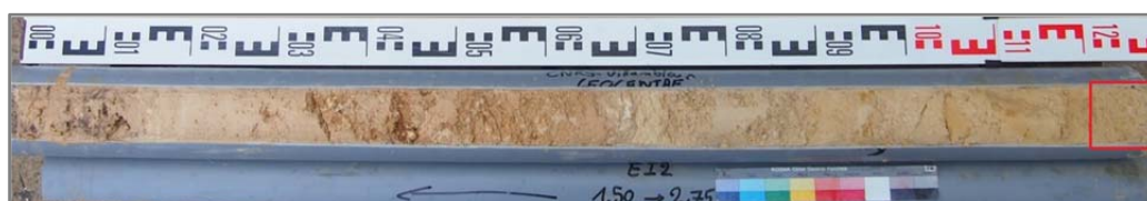
Figure 12- 17 Prélèvement d'un échantillon de sol (carré rouge) pour l'analyse de surface spécifique de grains (2,7-2,8 m-SC2).
