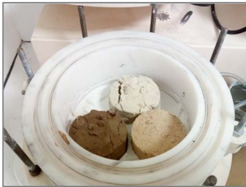
Figure 9- 13 Mise en place des a) échantillons cylindriques et b) mottes dans la presse de Richards avant la fermeture de l'enceinte.
