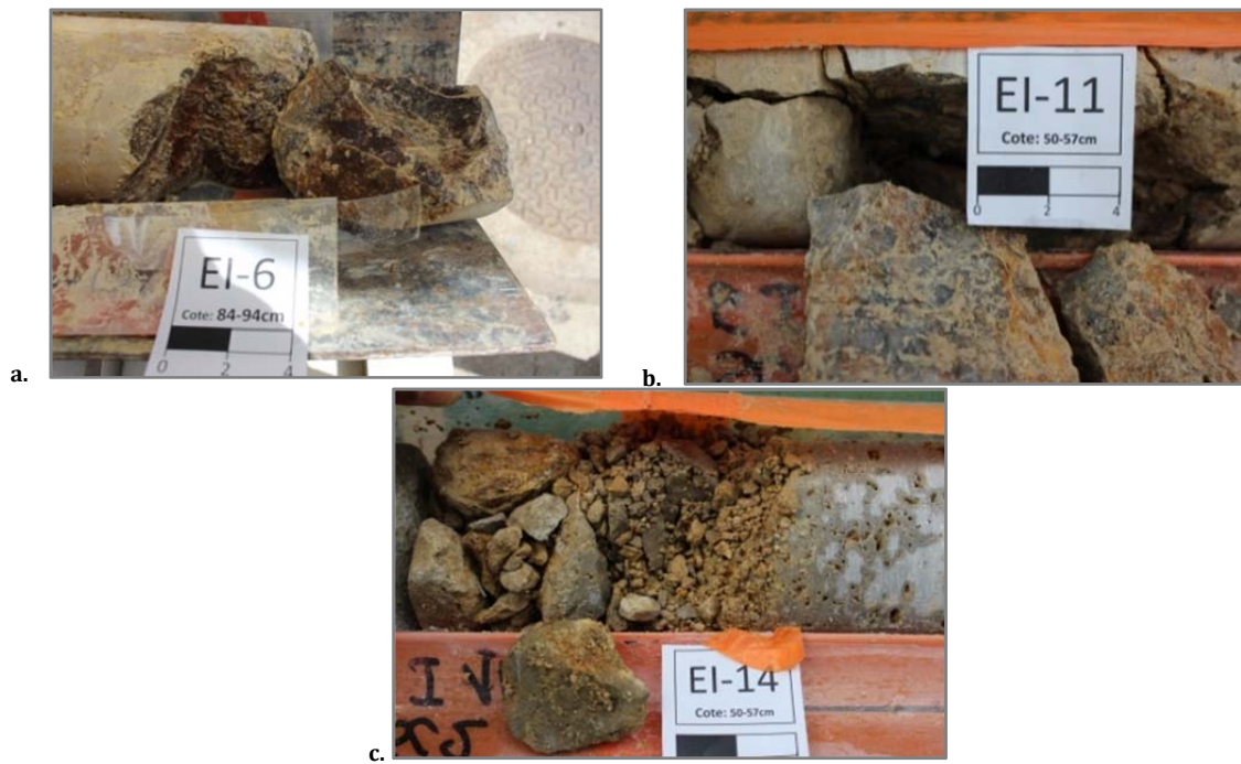
Figure 13- 4 a) Fracture avec précipitation des oxydes à 6,85 m -SC2, b) Fracture à 11,5 m-SC2, c) roche avec des vacuoles et débris grossiers à fins à 14,65 m-SC2.
