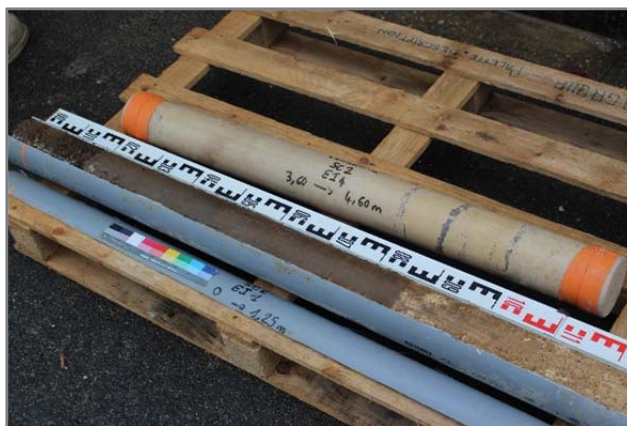
Figure 10- 4 Taux de récupération élevé (environ 100 %). SC2. Carottage à sec avec poinçonneur.
