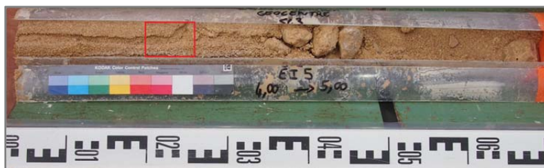
Figure 12- 9 Echantillon de sable prélevé (carré rouge) pour l'analyse granulométrique (prof : 4,2-4,25 m-SC3).
