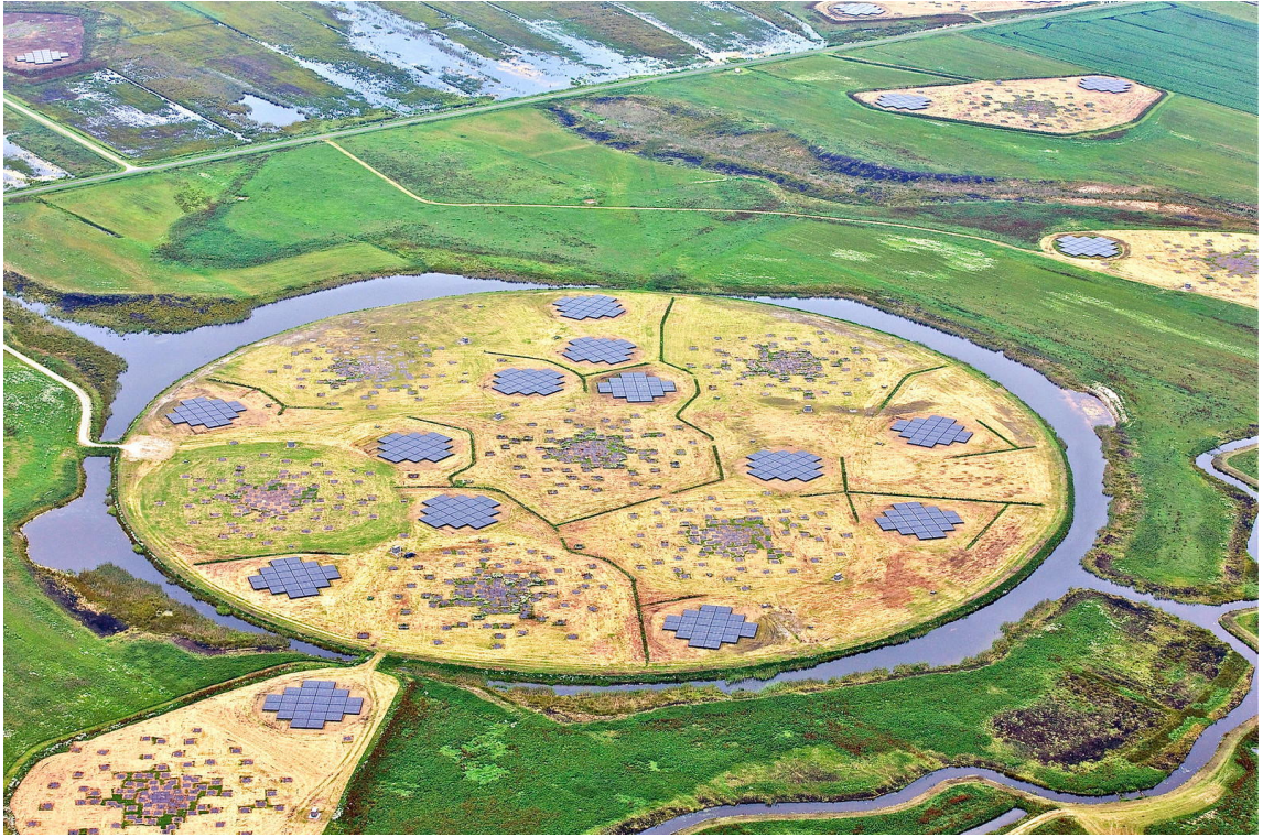
FIGURE 6.3 – Photographie aérienne du cœur de LOFAR à Dwingeloo aux Pays-Bas montrant les antennes HBA et LBA. Figure extraite de van Haarlem et al. (2013).
