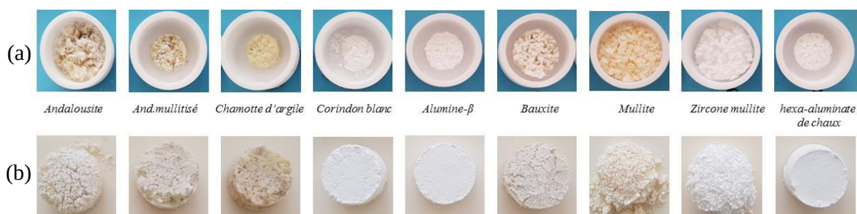
Figure IV.5-2 Photographies des pastilles après essai de corrosion à 1200°C a) Grains de granulométrie 0.5-1.6mm b) Grains de granulométrie < 63 \mu\text{m}
