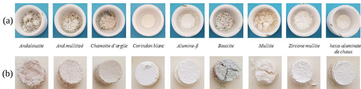
Figure IV.5-1 Photographies des pastilles après essai de corrosion à 800°C a) Grains de granulométrie 0.5-1.6mm b) Grains de granulométrie < 63 \mu\text{m}
