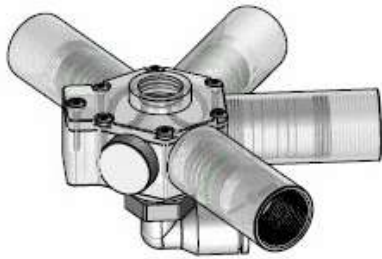
Fig. 2-19 : Vue 3D du compteur prototype réalisé au CNES.
