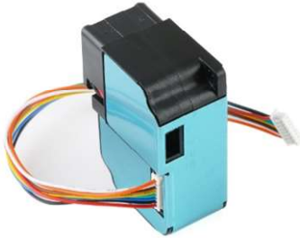
Fig. 2-10 : Photomètre miniature numérique ZH03B de Plantower disponible pour 10€
