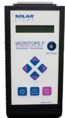
Fig. 2-11 Photomètre solaire portable de la société SunPhotometer.
