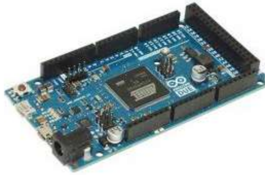
Fig. 3-53 : Carte Arduino DUE utilisée pour la mise au point et les tests de performance du système de régulation de la puissance de la diode laser.
