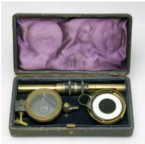
Fig. 2-2 : Conimètre portable développé par Aitken (1890).
