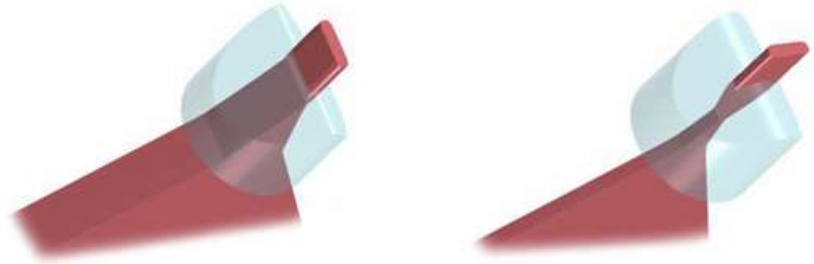
Fig. 3-65 : Elargissement d'un faisceau laser par une lentille de Powell (source LaserLine [126]).
