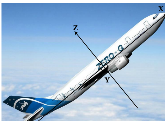
FIGURE 2.1 – Airbus A310 Zero-G et définition des axes x , y et z de l'avion – Crédits Novespace
