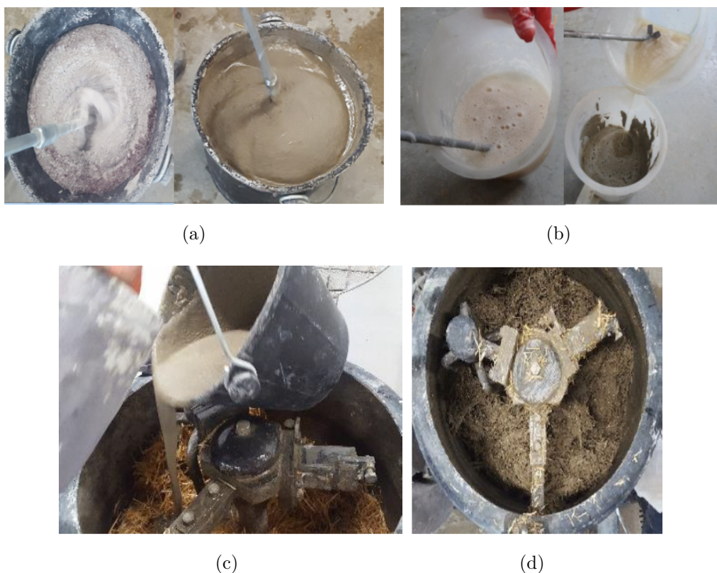
FIGURE 1.6 – Processus de fabrication des composites (a)Préparation du liant avec l'hémoglobine et la caséine (c) Préparation du liant avec gélatine (d) Mélange des constituants
