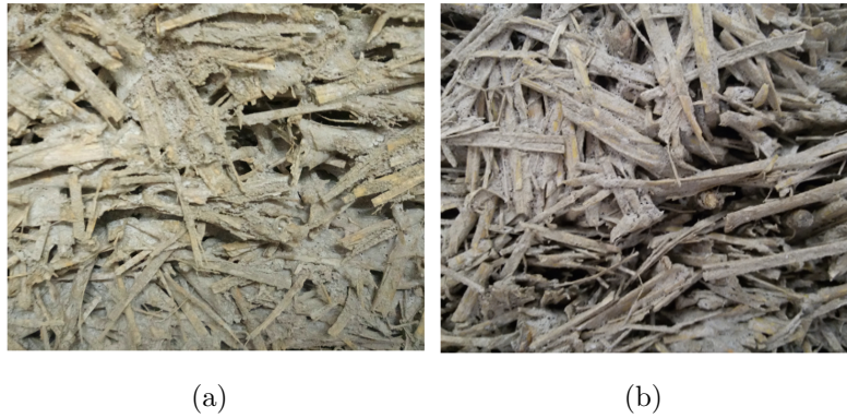
FIGURE 2.19 – Aspect des composites (a) Fort dosage en liant (b) Faible dosage en liant.
