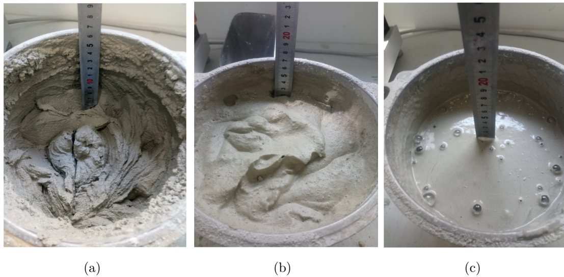
FIGURE 5.8 – Texture des mortiers à la fin du malaxage (a ) Référence (sans additif) (b) avec hémoglobine (c) avec caséine
