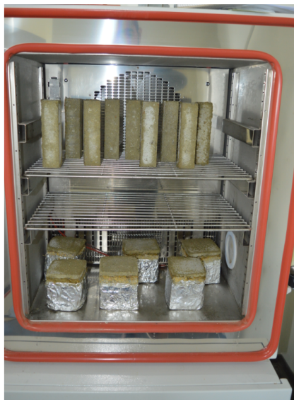
FIGURE 5.19 – Mise en place des échantillons dans l'enceinte climatique
