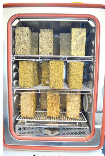
FIGURE 4.1 – Mise en place des échantillons dans l'enceinte climatique
