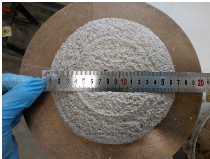
FIGURE 5.6 – Détermination de diamètre d'étalement au mini-cône (NF EN 459-2 2010 [153])
