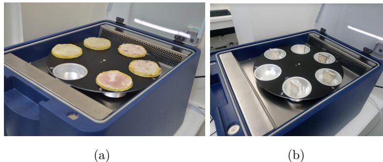
FIGURE 5.16 – Dispositif Vsorp pour la caractérisation hydrique (a) perméabilité à la vapeur d'eau (b) isothermes d'adsorption-désorption
