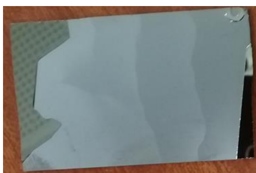
Figure IV-1. Détachement par morceau d'un substrat à 700 °C pendant 5 minutes.
