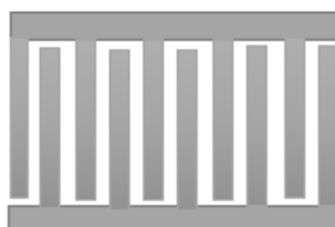
Figure IV-21. Contacts métalliques dans une structure IBC : Bus Bars
