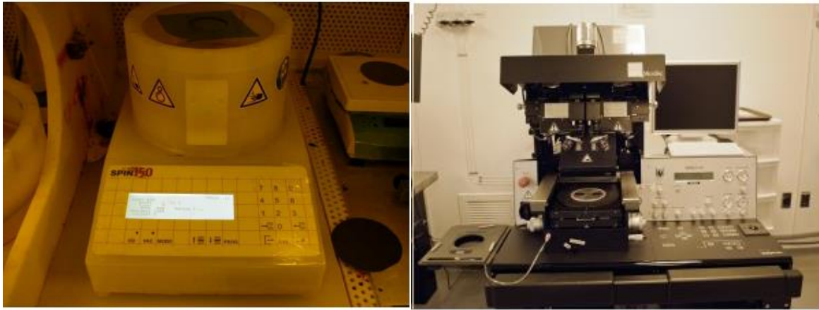
Figure II-21. Spin Coating pour le revêtement de la résine sur le substrat à gauche et Laser pour la formation des images latentes dans la résine à droite
