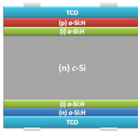
Figure I-22. Représentation schématique de la structure standard hétérojonction [38]
