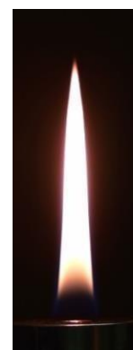
Figure III.1.13 : Flamme de diffusion de jet de méthane contenant 10% d'acétylène. Q_{CH_4}=4,05 \text{ cm}^3/\text{s} , et Q_{C_2H_2}= 0,45 \text{ cm}^3/\text{s}
