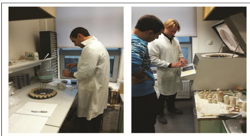
Figure 38 : La perte au feu des sédiments de la retenue de seuil de Saint-Hilaire à l'Université de Tallinn en Estonie (Photo réalisée par Francesco Donati).
