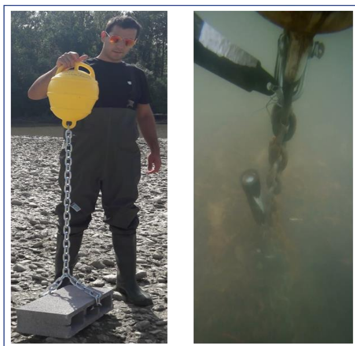
Figure 23 : Les chaînes de thermomètres que nous avons utilisée dans les retenues de seuil (à gauche). Les thermomètres « HOB0 U22-00 » immergés dans l'eau (à droite) (Photos réalisées par Francesco Donati,
