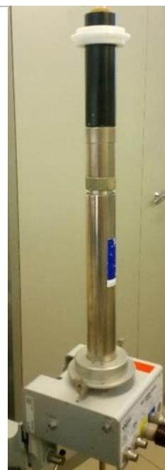
Figure 20 : Sonde de diffusion avec fourreau de gradient.
