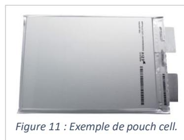
Ces *pouch cells* réalisés en laboratoire ont des électrodes rectangulaires de dimensions arbitraires. Ils sont généralement assemblés à l'air libre (idéalement en salle sèche), puis séchés sous vide dans une enceinte, pour ensuite être introduits en boîte à gants pour l'activation et le scellage sous vide. Ces *pouch cells* n'ont pas de système de pression inclus. Il faut alors utiliser des plaquettes associées à des pinces de bureau pour y remédier et pouvoir les cycler correctement.
