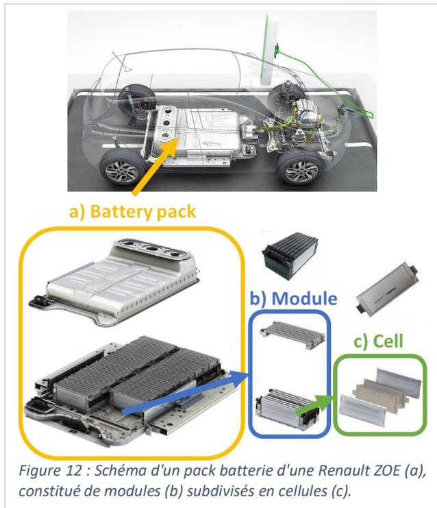
Figure 12 : Schéma d'un pack batterie d'une Renault ZOE (a), constitué de modules (b) subdivisés en cellules (c).
