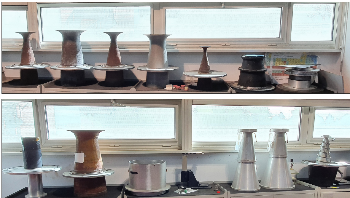
FIGURE 2.5 – Photographie de quelques tuyères dont dispose le moyen d'essais de MARHy.
